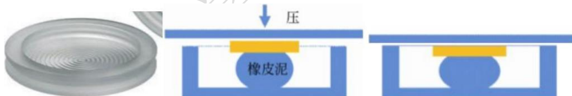
图 6-4 不规则形状固体样品或带基底样品的制备
