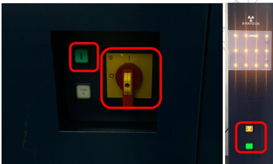
图 6-7 XRD 主机电源开关 (左)、高压按钮 (右上)、仪器状态指示灯 (右下)
