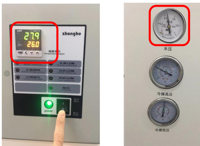
图 6-6 水冷机温度及水压示意图
