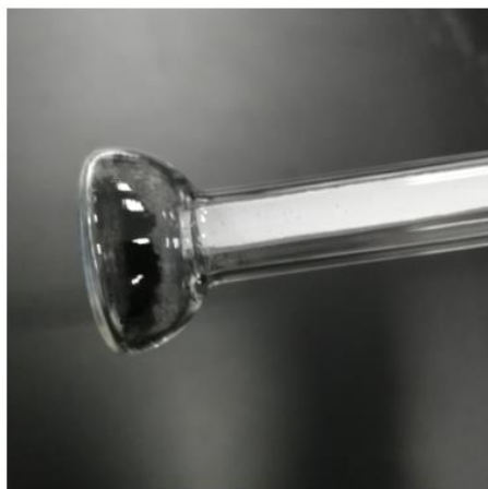
使用纸槽将样品装入已称重的样品管, 避免样品粘在管壁
