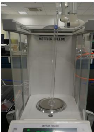
称量空管质量, 若测试过程中需要加填充棒则一起称量
