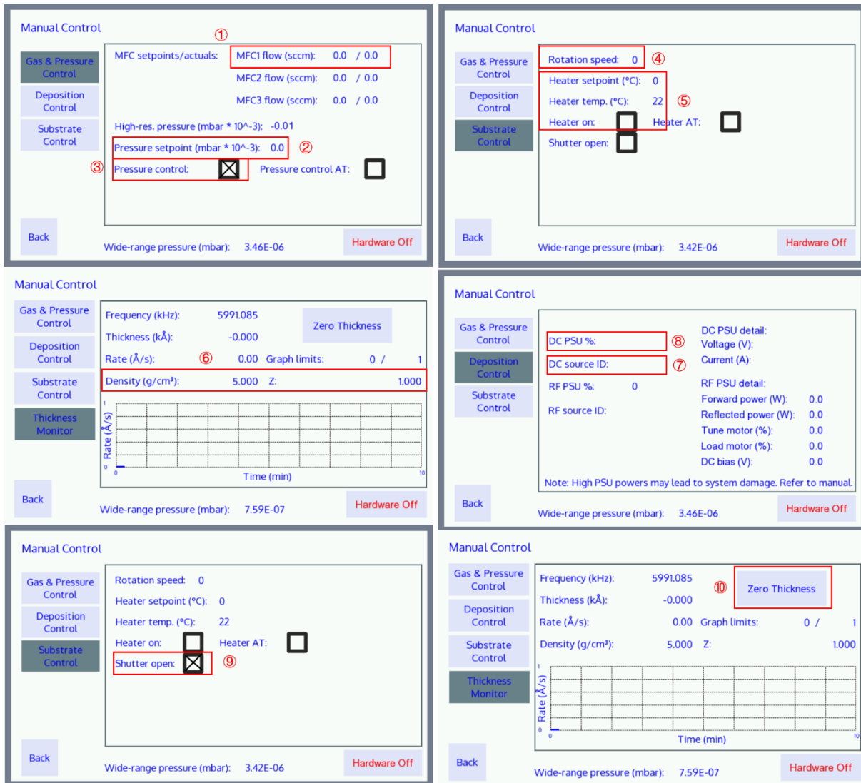
图 6.9 溅射操作步骤
