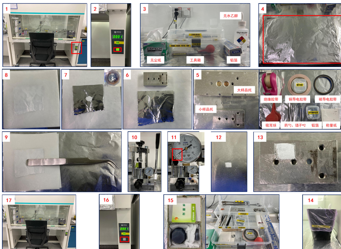
图 9 粉末样品制备过程示意图
